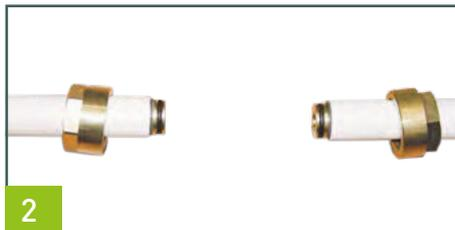
Mesurez le diamètre interne du tuyau avec la jauge. Prenez les manchons de support appropriés selon le diamètre interne mesuré du tuyau et poussez-les dans les deux extrémités du tuyau jusqu'au bout. Dévissez les écrous et placez les deux écrous sur les deux extrémités du tuyau.
