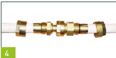
Placez le corps en réglant la longueur en direction des extrémités du tube jusqu'à ce que les extrémités s'enclenchent de manière audible sur les douilles de serrage.
