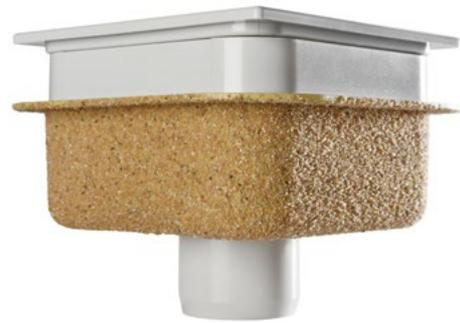
Un sottile strato di sabbia, aderente alla superficie d'acciaio dello scarico dei prodotti Gebo Drain, consente la massima performance in termini di presa al massetto e semplicità di posa, sia per le pilette che per le canaline. Le caratteristiche della sabbia,
