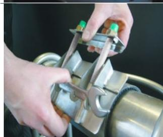
La funzione "EasyGrip" segue il principio della leva: Premere con una mano il bordo inferiore del collare e la chiave inglese. Il supporto mobile può ora essere comodamente appoggiato sul bordo superiore del collare in acciaio inox con l'altra mano.
