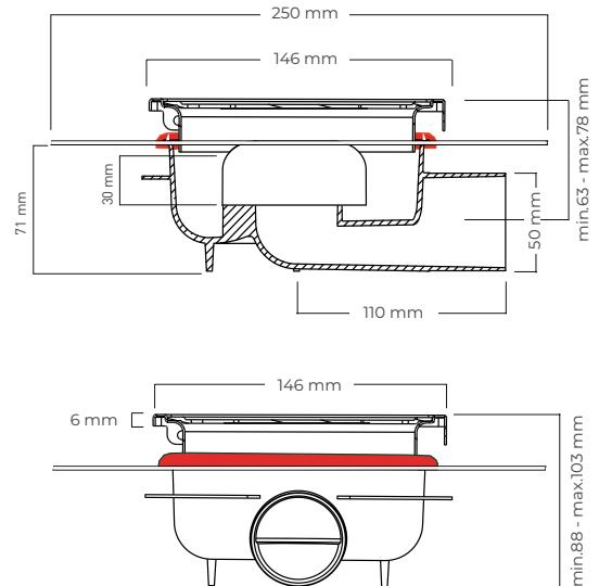
Los productos de la serie smart LINE son ideales para la instalación en platos de ducha. El moderno diseño de la rejilla ofrece una elegante y agradable apariencia, y a su vez, garantiza una instalación fácil gracias a la lámina premontada.
